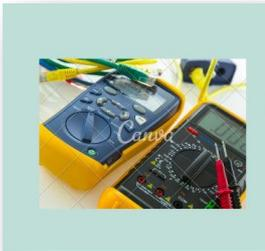
Pour ce faire, nous utilisons des testeurs de câbles et, si nécessaire, sur les grandes installations, des certificateurs de câbles **Certificador de cables** qui nous permettront de définir la vitesse de la liaison.
